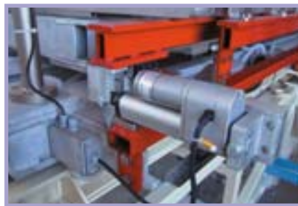
Detalle de un accionamiento, para el cambio de formato automático.
