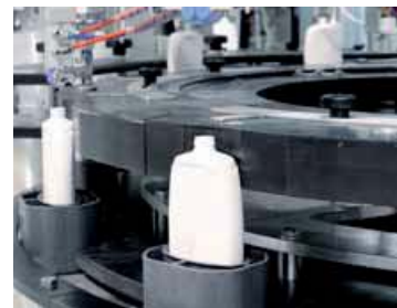
4 - Dettaglio sistema alimentazione puck
