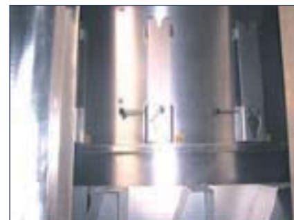
Fase numero 5 Vista del sistema di fissaggio in posizione aperta dell'evacuatore.
