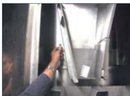
Fase numero 7 Il perno di bloccaggio viene inserito.
