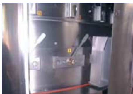
Fase numero 1 Vista del sistema di fissaggio a leva in posizione aperta del separatore.
