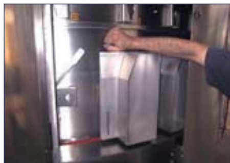
Fase numero 3 La leva viene fatta ruotare fino a bloccare il separatore.
